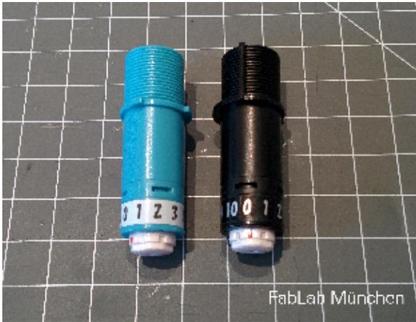
Das Messer ist einstellbar in Schnitt-Tiefen von 0 mm bis 1 mm - in 0,1 mm Schritten - das entspricht der Skala von 0 bis 10. Ein Skalen-Wert entspricht also 0,1 mm Messertiefen-Änderung.
