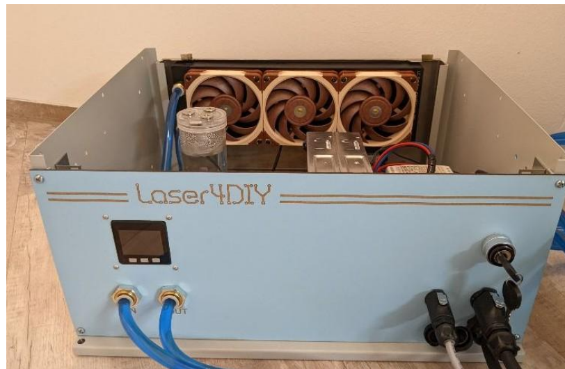
Geöffnete Versorgungseinheit: links der Ausgleichsbehälter mit integrierter Pumpe, hinten die Radiatoren des Kühlsystems
