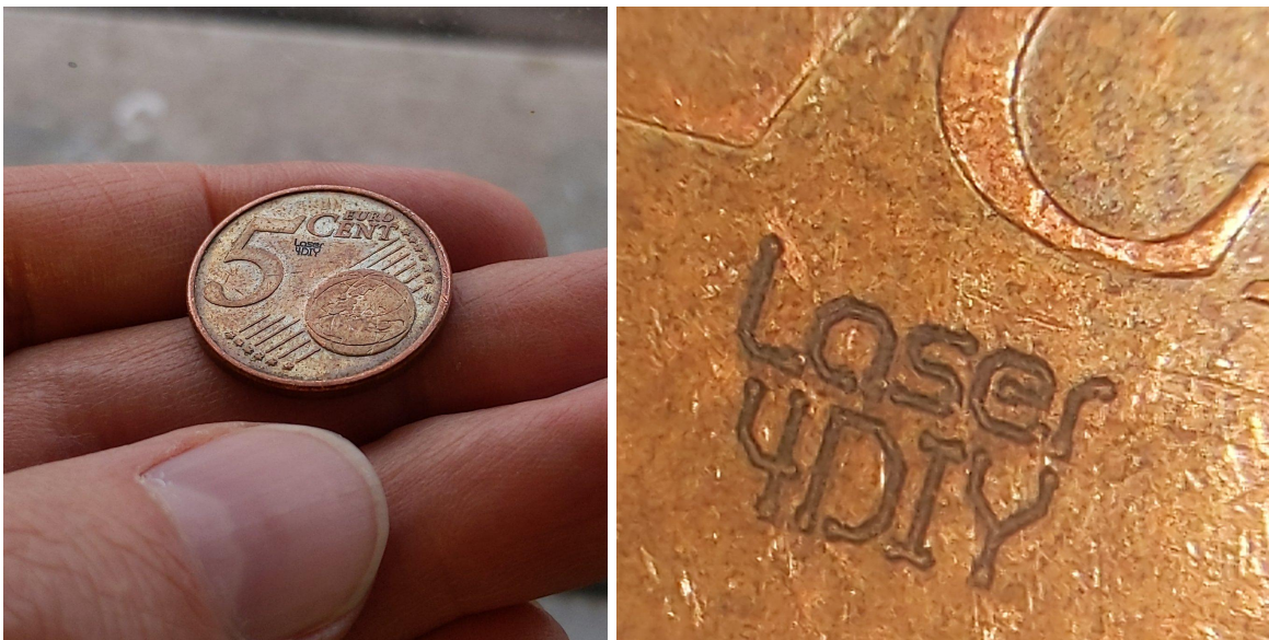
Fein aufgelöste Gravur des LASER4DIY-Logos auf einer Münze, erstellt mit dem LaserPCB
