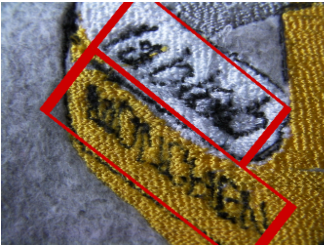
Bild: Outlines auf gefüllten Flächen fallen sehr dünn aus. Kann hier jemand fablab München lesen? Ich nicht.
