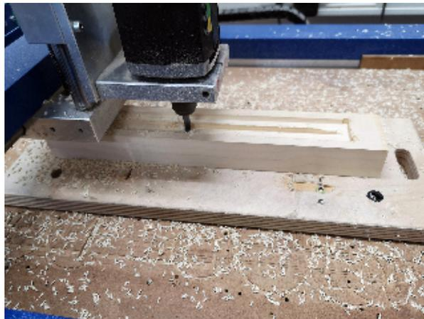
Aus einem Stück Ahorn-Vierkantholz wird mit der CNC-Fräse der benötigte Platz für die LED-Module, Elektronik und Ansteuerung ausgefräst. Hierbei ist wichtig, die Ausfräsung so präzise wie möglich auszuführen, damit danach die Display-Module streng im Holz sitzen.
