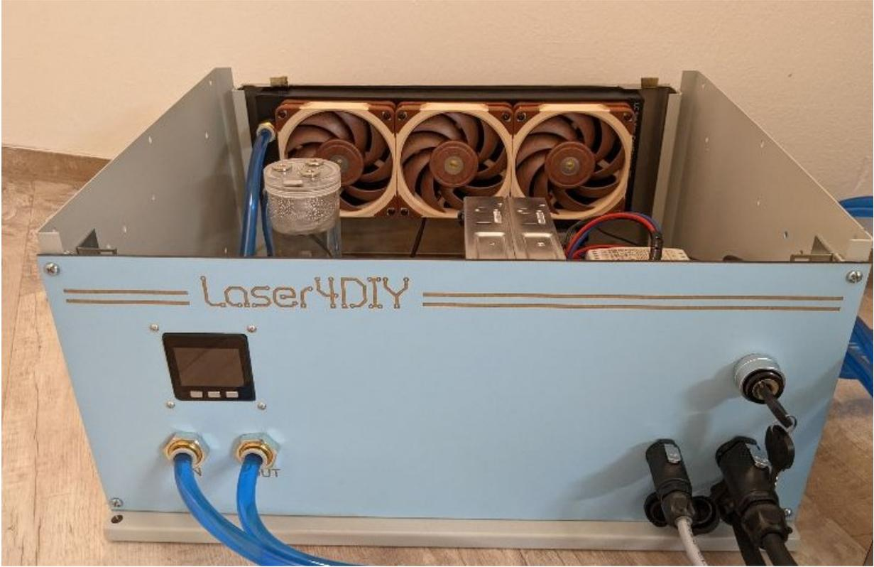
*Geöffnete Versorgungseinheit: links der Ausgleichsbehälter mit integrierter Pumpe, hinten die Radiatoren des Kühlsystems*
