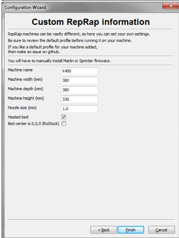
Die Maschinen-Größe haben wir hier mit 380x380x330mm etwas kleiner als die offizielle Größe angegeben, weil das Heizbett am Rand kühler ist (x/y-Richtung) und durch Umbauten die Höhe bei uns etwas kleiner ist.
